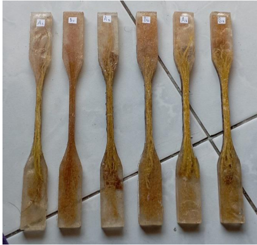
Gambar 1. Sampel uji Kuat Tarik
