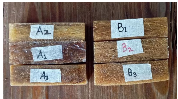
Gambar 2. Sampel Uji Impact
