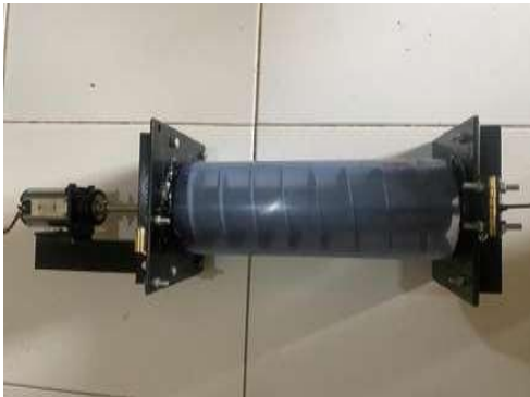
Gambar 15. Turbin yang sudah dirakit
