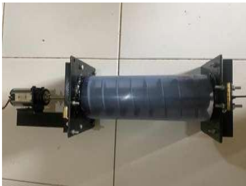
Gambar 15. Turbin yang sudah dirakit
